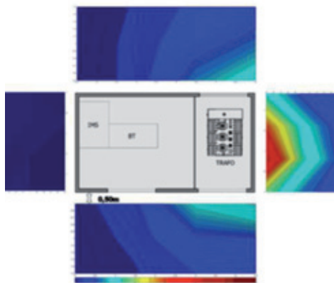
Figura 4.15: Esempio di distribuzione spaziale del vettore induzione magnetica B [ \mu T ] attorno la cabina
