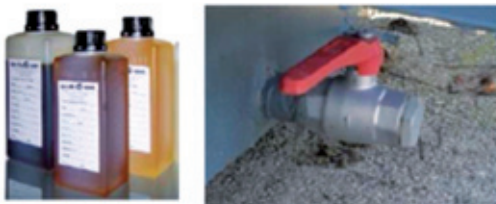
Figura 4.3: Prelievo di campioni di olio dal trasformatore
