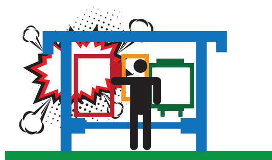
Figura 1.19: Classificazione arco interno IAC-A
