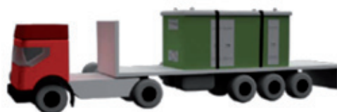
Figura 1.22: Trasporto della cabina
