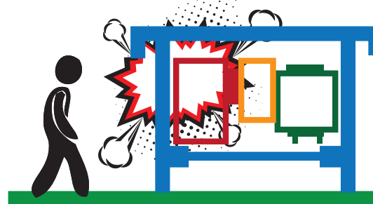
Figura 1.20: Classificazione arco interno IAC-B
