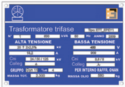
Figura 4.2: Targa di un trasformatore
