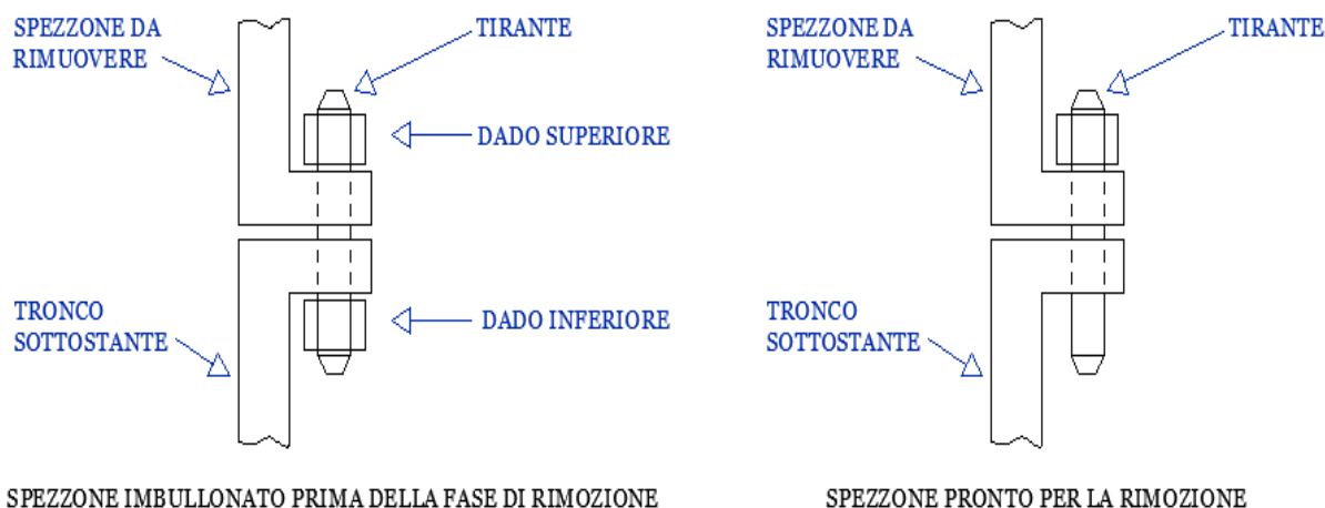
Figura 23: Predisposizione bulloneria per rimozione spezzone
